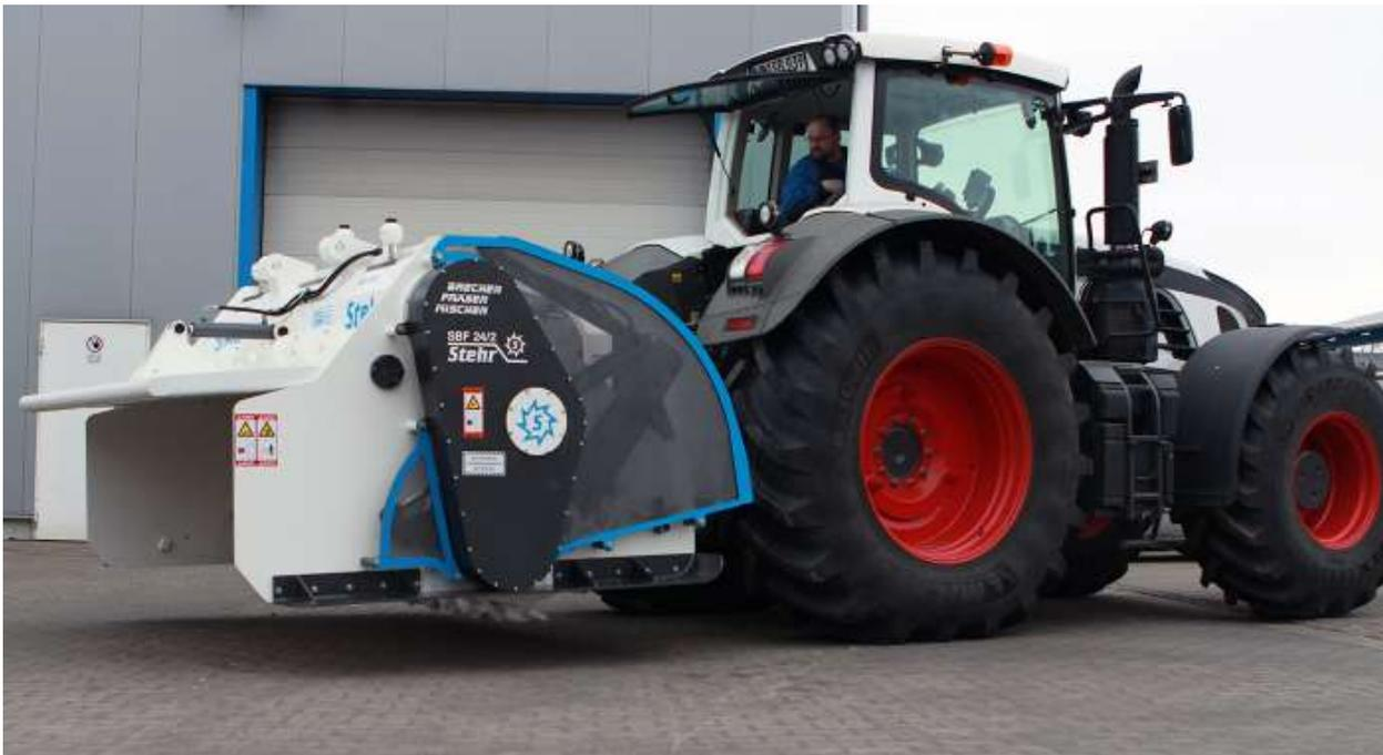
**Da die Trägergeräte immer größer und stärker werden, haben wir reagiert: Die Bodenstabilisierungsfräse SBF 24/2 – die stärkste auf dem Weltmarkt – ist ausgelegt für eine Antriebsleistung bis 600 PS !!!**
